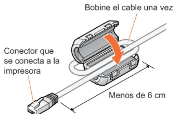
La solución más extendida es el empleo de **anillos de ferrita**, que deberíamos colocar en cada uno de los cables. Bloquean bastante las interferencias de radio AM, pero también suelen influir en el flujo de la señal por viaje por el cable, por lo que en determinados tipos de cableados y equipos de imagen y sonido no es recomendable. Generalmente no dan problemas en equipamientos normales.
